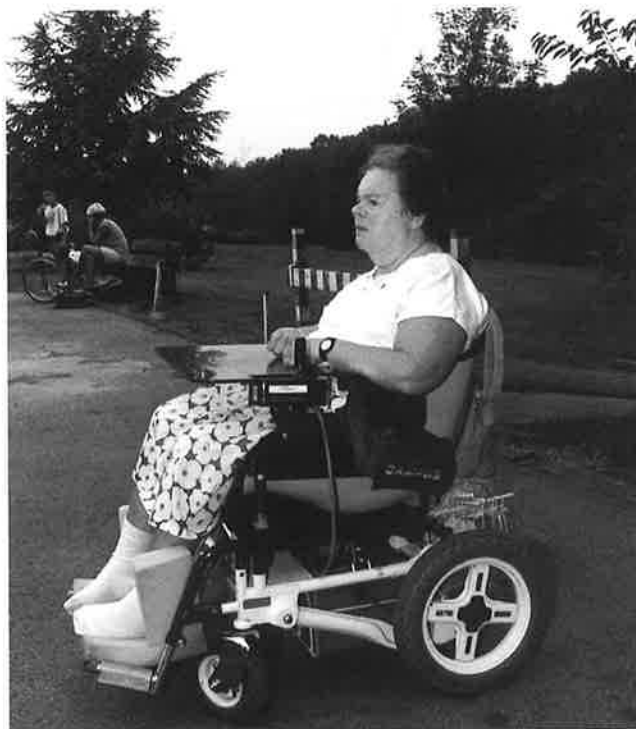
Corset-siège placé sur fauteuil à propulsion électronique. Le fauteuil est également équipé d'une tablette favorisant le positionnement des bras et permettant différentes activités.
