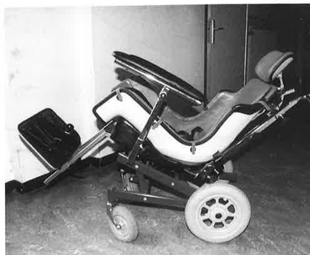
Corset-siège placé sur un châssis pour fauteuil «à pousser». Châssis avec dossier inclinable; ici le siège est en position inclinée.
